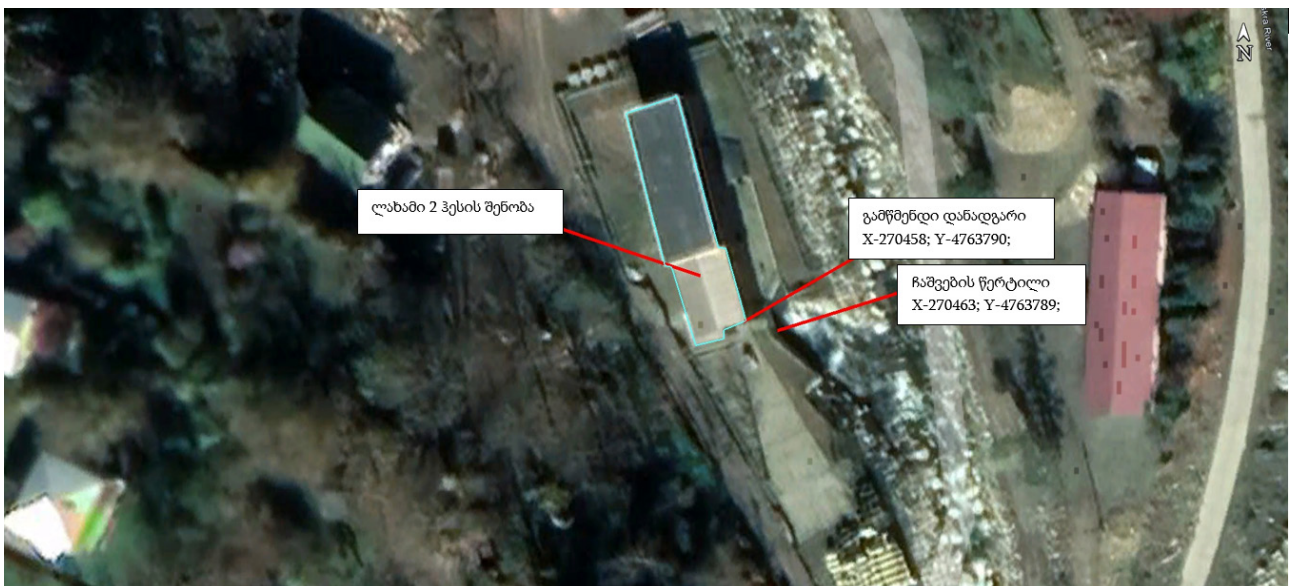
სურათი 3.4. ბიოლოგიური გამწმენდი ნაგებობის და ჩამდინარე წყლების ჩაშვების წერტილის განლაგების სქემა
